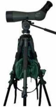
Mit Riemen und Ösen am Stativ befestigtes Mulipack
